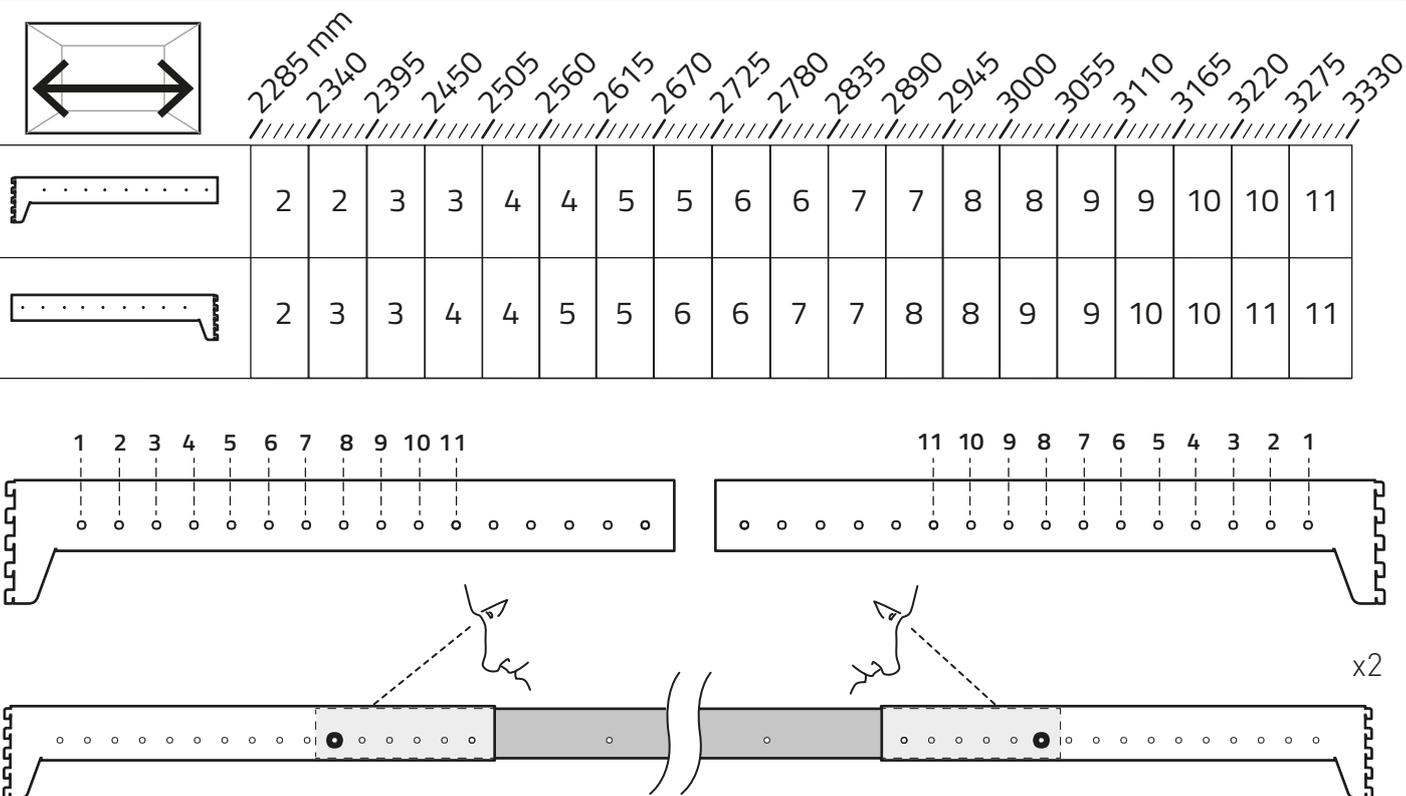
Ex : Largeur souhaitée = 3100 mm / Montant gauche = position 9 et Montant droit = position 9
